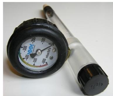
Il tensiometro misura la pressione di aspirazione dell'acqua nel suolo (= potenziale idrico del suolo) cioè misura la forza con la quale l'acqua viene trattenuta nel suolo e quindi la forza che le radici della pianta devono esercitare per estrarre acqua dal terreno.
