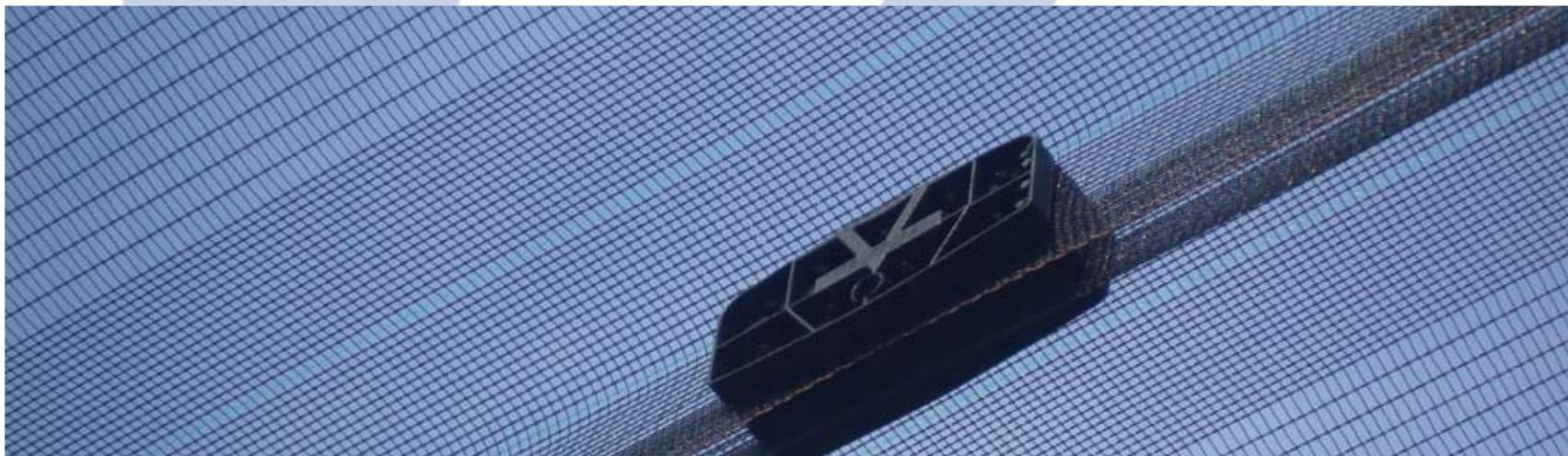
chiamata tessitura a telaio; la maglia che si ottiene con questo tipo di lavorazione è di forma rettangolare 2,8 x 8mm ed è indeformabile, cioè le dimensioni non variano quando la rete è sottoposta ai carichi della grandine.
